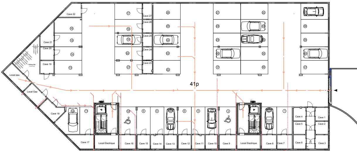
La rangée de parking et les 2 sas d'entrée seront allumés par séquences sur minuterie afin de gérer la sécurité des lieux et d'atténuer le degré d'éclairage durant la nuit tout en garantissant l'éclairage d'orientation de confort en permanence. Certains luminaires seront équipés de détecteurs de présence.
